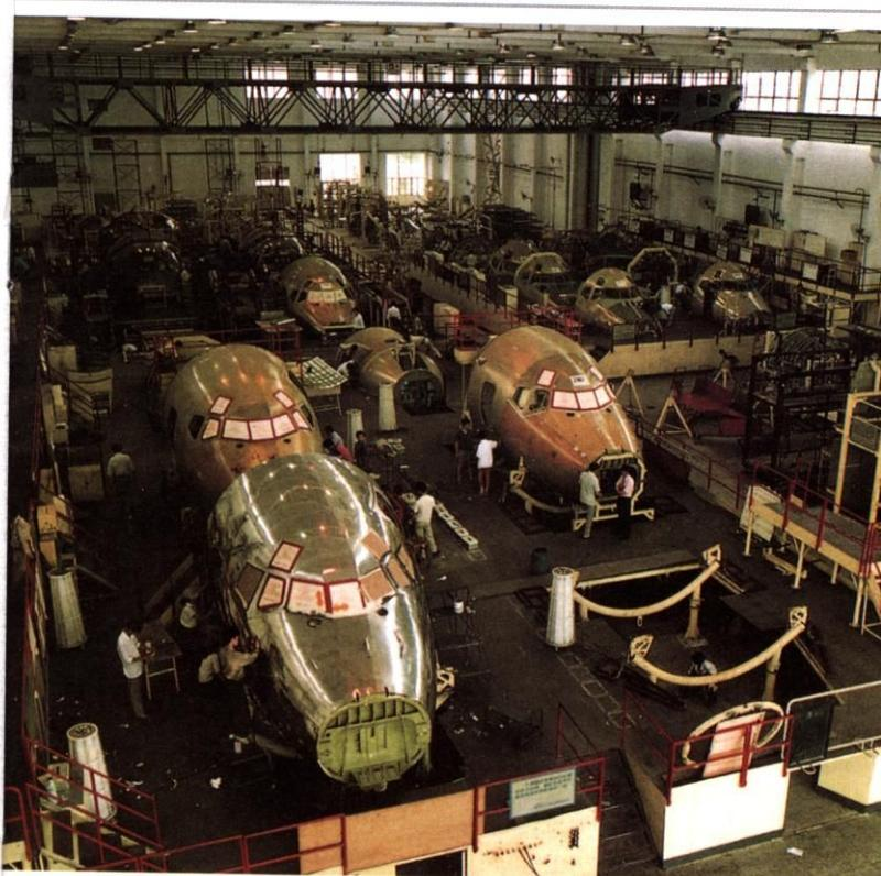
Линия сборки узлов к самолету «МД-82» (производства США).
